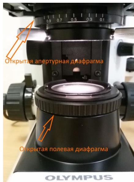
Открытые апертурная и полевая диафрагмы
